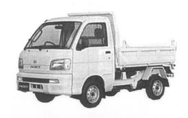
三方のゲートを倒せば固定柱のない フラットな荷台に変わります。
